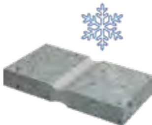
Kontrakce stavebních prvků
